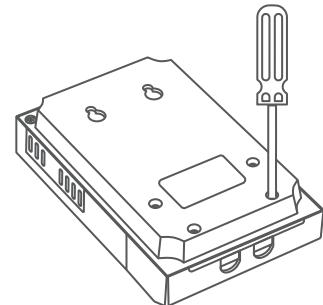
(3) چهار عدد پیچ نگهدارنده کابل های ورودی/خروجی را باز نمایید.
