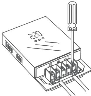
(5) نگهدارنده کابل ها و قاب روی دستگاه را توسط پیچ بیندید و محافظ GREEN Line GLP301 EVO را روی پیچ های نصب شده قرار داده و برق را وصل نمایید.
